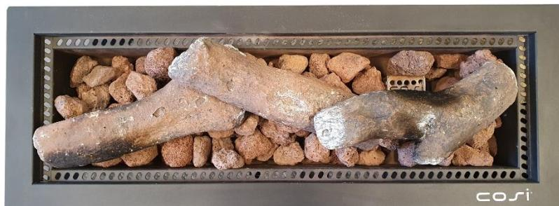
Houd zoveel mogelijk rondom de ontstekingsunit vrij van lavastenen en houtblokken. Zorg ervoor dat de brandring zo min mogelijk bedekt wordt door de houtblokken. Als de stammen de vuuring blokkeren, kunnen er gevaarlijke situaties ontstaan. De blokkade van de vuuring zal de luchtstroom van de ring beïnvloeden en de vlammen zullen anders zijn. Dit resulteert in gevaarlijke situaties!
