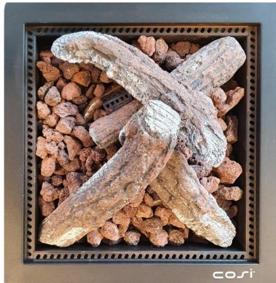
Houd zoveel mogelijk rondom de ontstekingsunit vrij van lavastenen en houtblokken. Zorg ervoor dat de brandring zo min mogelijk bedekt wordt door de houtblokken. Als de stammen de vuurring blokkeren, kunnen er gevaarlijke situaties ontstaan. De blokkade van de vuurring zal de luchtstroom van de ring beïnvloeden en de vlammen zullen anders zijn. Dit resulteert in gevaarlijke situaties!
