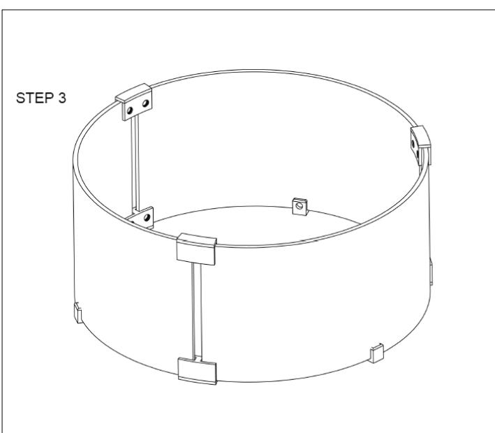
Plaats de drie bovenste verbindingssstukjes aan de bovenzijde van de glasplaatjes, zoals op de tekening. Schroef de verbindingssstukjes vast. Controleer of alle verbindingssstukken goed vast zitten en plaats dan de glasset op jouw vuurtafel.
