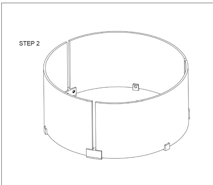
Pak de drie glasplaatjes en vorm ze samen tot een cirkel. De glasplaat dient zowel links als rechts in de verbindingssstukjes te worden bevestigd. Het is eenvoudiger om de montage met twee personen te doen. Schroef de meegeleverd schroeven in de verbindingssstukjes.
