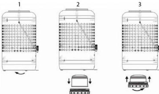
Om det finns en lukt av gas, eller om du misstänker en läcka när patronen har monterats, ta apparaten till en väl ventilerad utomhus plats bort från någon antändningskälla. Om du vill söka efter läckor i enheten gör du det utanför. Försök inte att detektera läckor med hjälp av en flamma; Använd såpvatten.
