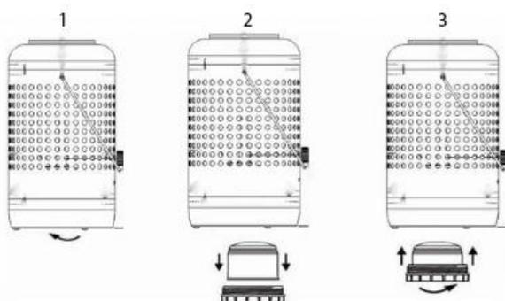
Hvis der er en lugt af gas, eller du har mistanke om en lækage, når patronen er blevet monteret, så tag apparatet til en godt ventileret udendørs placering væk fra enhver antændelseskilde. Hvis du vil søge efter lækager i din apparatet, skal du gøre det udenfor. Forsøg ikke at detektere lækager ved hjælp af en flamme; Brug sæbevand.
