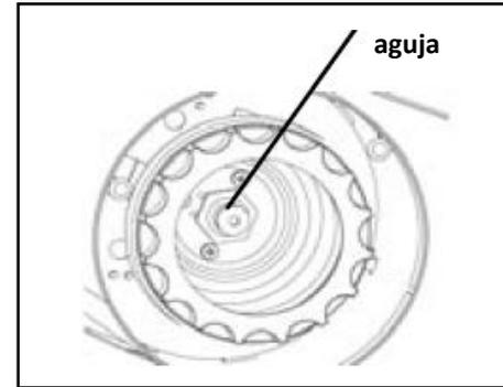
Si hay un olor a gas o sospecha que hay una fuga una vez que el cartucho ha sido colocado, lleve el aparato a un lugar bien ventilado al aire libre, lejos de fuentes de ignición. Si desea verificar si hay fugas en su electrodoméstico, hágalo afuera. No intente detectar fugas usando una llama; usa agua jabonosa
