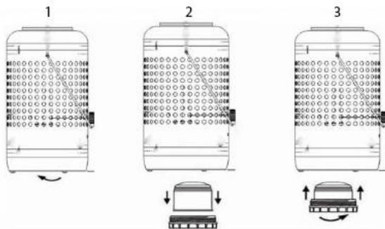
Plaats de gascartouche in de draaibare vergrendeling van de gascartouche. Draai daarna de gascartouche van onderaf in de gaslantaarn. Zorg ervoor dat de gascartouche met het prikmechanisme precies in de afdichtring wordt geplaatst. Draai de vergrendeling met de klok mee zo ver door tot hij niet verder kan.
